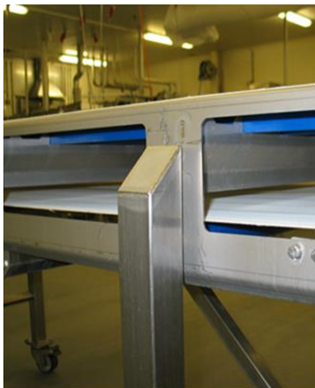
Figuur 4 Schuine kant bovenop standers.
