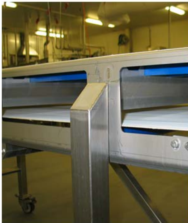
Figuur 3 Afstandsbussen bij staanders en schuine kant bovenop.
